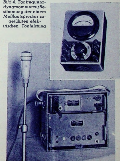
Bild 5. Meßkondensatormikrofon 30 bis 15000 Hz von Rohde & Schwarz; 1. Verstärkerstufe direkt an der kugelförmigen Kapsel angebaut
